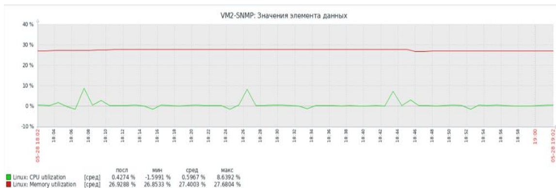
Рисунок 2. SNMP-мониторинг целевого сервера, где верхний график отображает memory utilization, нижний – CPU utilization
