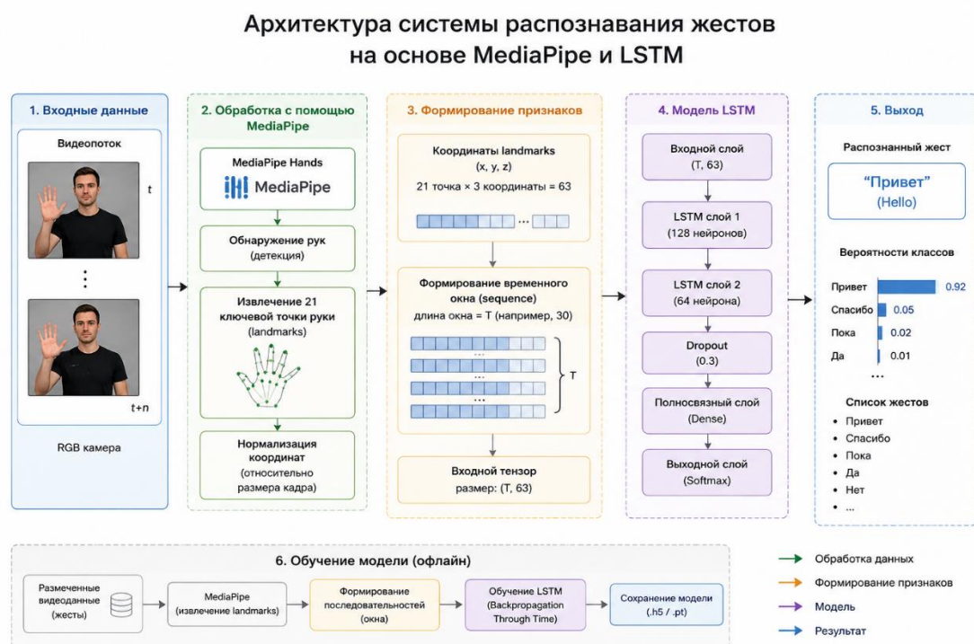
Рисунок 2. Архитектура системы распознавания жестов на основе MediaPipe и LSTM
