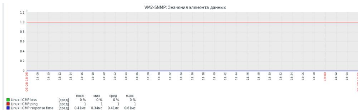
Рисунок 1. ICMP-мониторинг целевого сервера, где верхний график отображает ICMP ping, нижний график – ICMP response time
