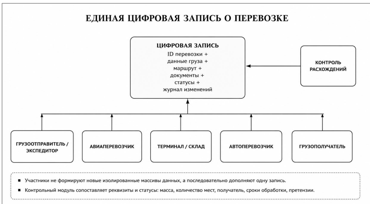
Рисунок 1. Схема обновления единой цифровой записи участниками мультимодальной перевозки
