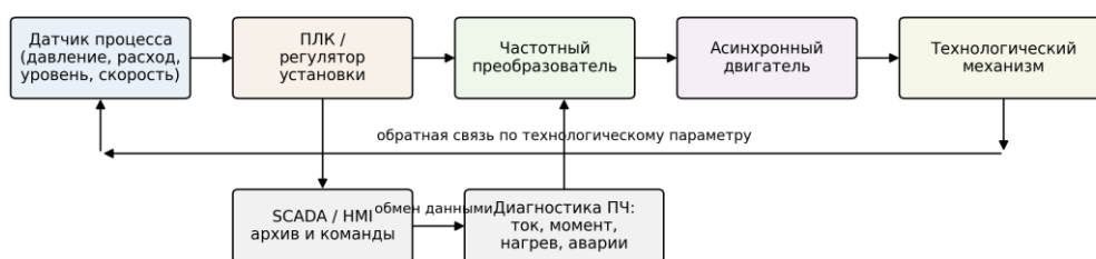
Рисунок 1. Функциональная структура частотно-регулируемого электропривода в составе АСУ ТП
